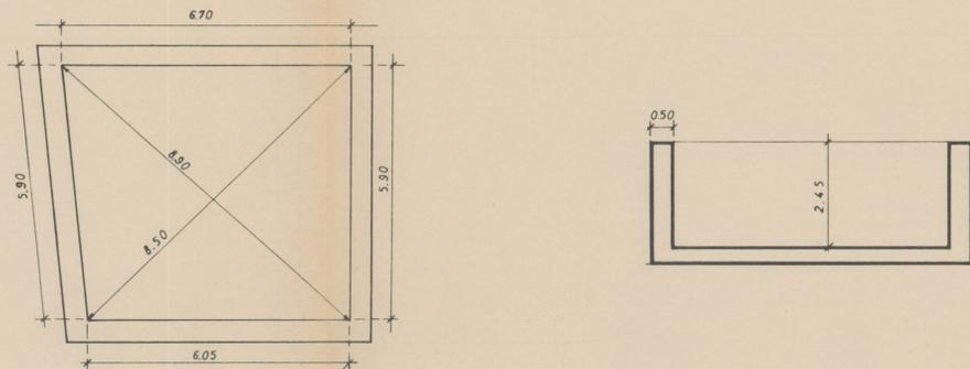
PLANTA Y SECCION DEL DEPOSITO EXISTENTE Nº 8
